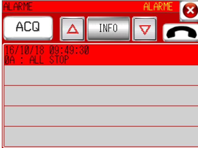
용접기는 안전을 위해 자동진단 기능이 있다. 알람이 발생하면 용접을 할 수 없다. 용접중 알람이 발생하면 용접기는 용접을 중지하고 포스트가스 단계로 진행된다. 자세한 정보를 보기위해 화살표와 "INFO" 버튼으로 세부정보 확인. 문제를 확인하고 해결후 "ACQ"버튼을 누르면 메시지가 녹색으로 바뀐다.
